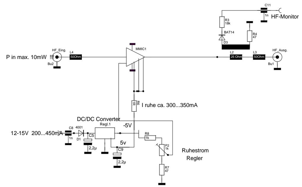
Hinweise: Bei Dauerbetrieb sollte die PA zur besseren Kühlung auf eine metallische Fläche montiert werden .
