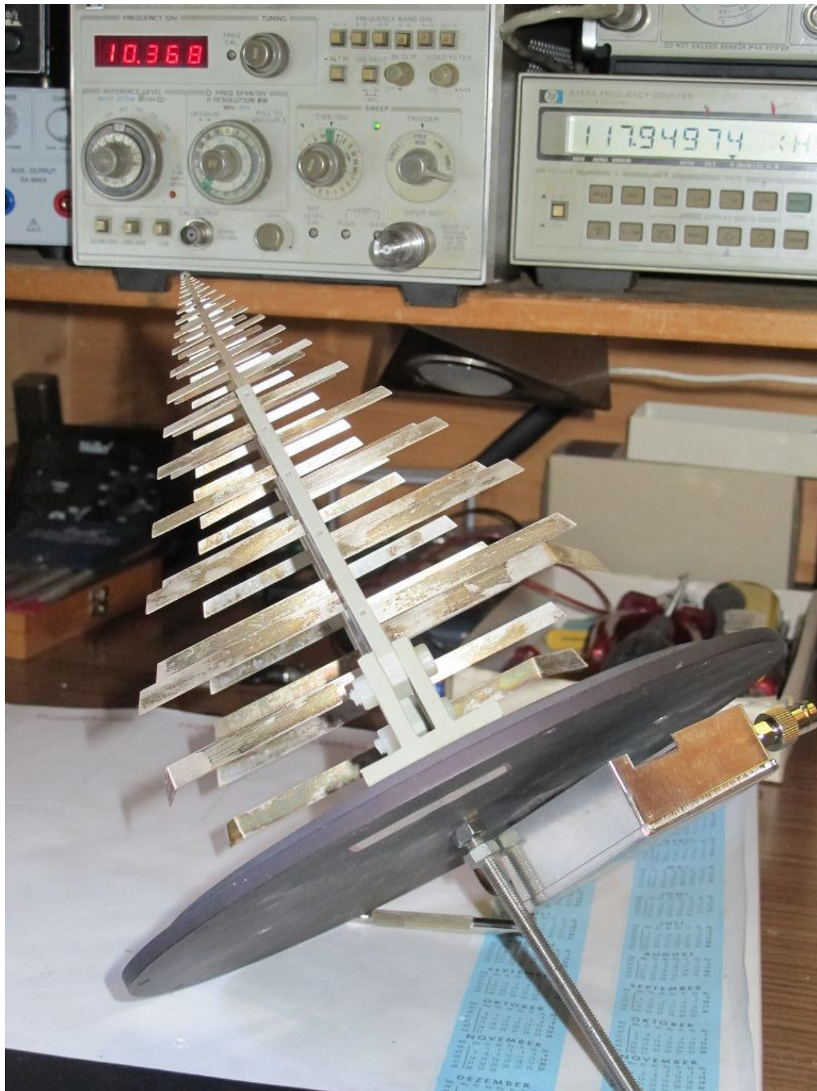
Bild 5 ( Portabelantenne 750 MHz – 24 GHz mit Radom für den Stativeinsatz)
